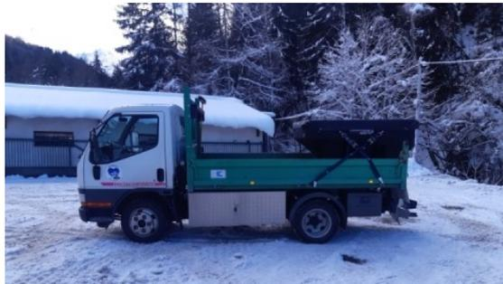
Achat d'une saleuse de 750 Litres mise en place sur le camion de 3.5T pour assurer le salage du village et pallier à l'absence de l'UNIMOG.
